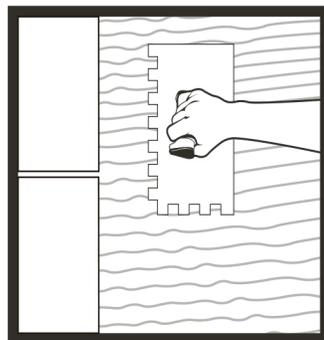
2. Aplicar una capa de PegaReal PREMIUM® PISO/PISO utilizando la parte lisa de la llana. Agregue más pasta y extienda con la llana dentada en forma homogénea en un área de 1,0 a 1,5 m<sup>2</sup>. Aplicar adhesivo en la cara posterior de la pieza cerámica.
