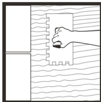
2. Aplicar una capa de PegaReal® PISOS Y MÁRMOL GRIS utilizando la parte lisa de la llana. Agregue más pasta y extienda con la llana dentada en forma recta en un área de 1,0 a 1,5 m<sup>2</sup>. Aplicar adhesivo en la cara posterior de la pieza.
