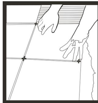
3. Es recomendable aplicar con la parte lisa de la llana una capa delgada de adhesivo en la parte posterior de la pieza. Colocar las piezas cerámicas, presionándolas y moviéndolas lateralmente eliminando las líneas de rayado.
