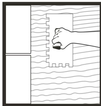
2. Aplicar una capa de PegaReal PREMIUM® GLOBAL con un espesor de 3 mm utilizando la parte lisa de la llana, agregue otra capa y peine la pasta con el lado dentado de la llana en forma recta en un área de 1,0 a 1,5 m<sup>2</sup>.
